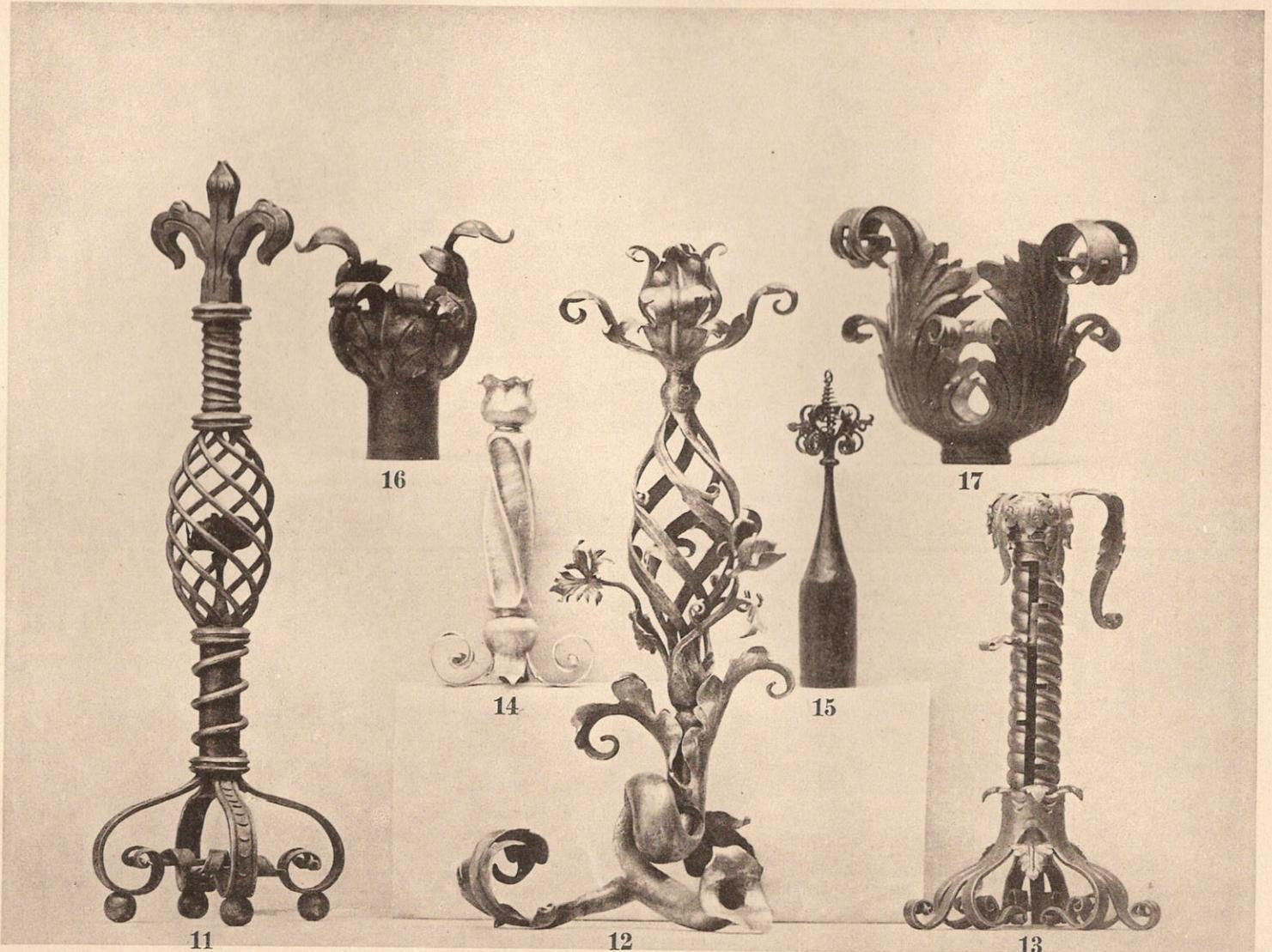
Abbildung 11: Ständer für Stammtischtafel und dergl., Abbildung 12, 13 und 14: Leuchter, 15: Nachbildung der Gitterspitzen am Gänsemännchenbrunnen zu Nürnberg, 16 und 17: Blumen für Gitterwerk. Die Gegenstände Abbildung 11 und 12 aus zwei Rohrstücken, 13 aus drei, alle übrigen aus einem Stück Stahlrohr, bis auf den Leuchter Abbildung 14, welcher aus einem Stück Aluminiumrohr hergestellt ist.
